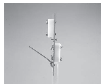
ネジは部品面側、半田面側両方から入れる事ができます。
